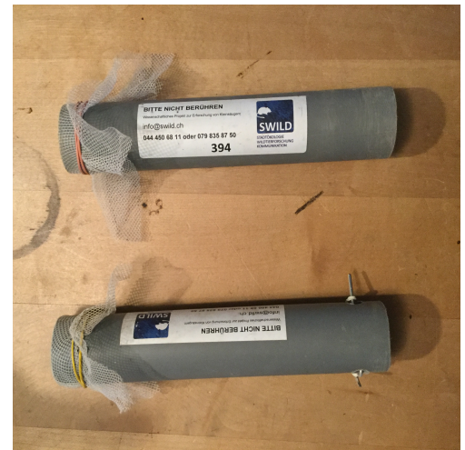
Bild 1: Zur Sammlung von Kotproben von Wasserspitzmäusen ( Neomys sp.) eingesetzte Kunststoffröhren. Unten eine Kotröhre mit der Ergänzung zur Sammlung von Haarproben.
