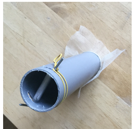
Bild 2: Kotröhre mit der Ergänzung zur Sammlung von Haarproben. Die Walze mit dem Klebeband ist mit einem Gummiband fixiert. Wenn sich die Spitzmaus unter der Walze durchdrängt, wird diese vom Rücken des Tieres angehoben und rollt über den Rücken. Dabei sollten einige Haare an der Rolle kleben bleiben.
